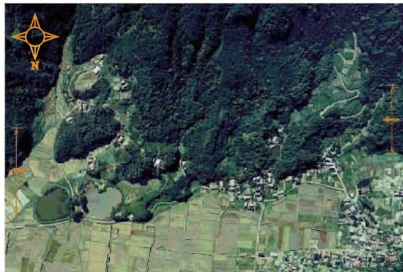
写真1：航空写真から読める断層変移地形（地形図①付近、下方向が北）
