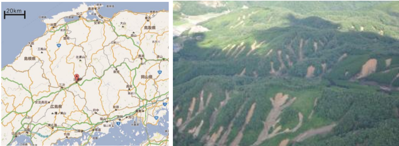
図 1 広島県庄原の位置(左)および表層崩壊の集中的な発生状況(右) 小川(2011) より
