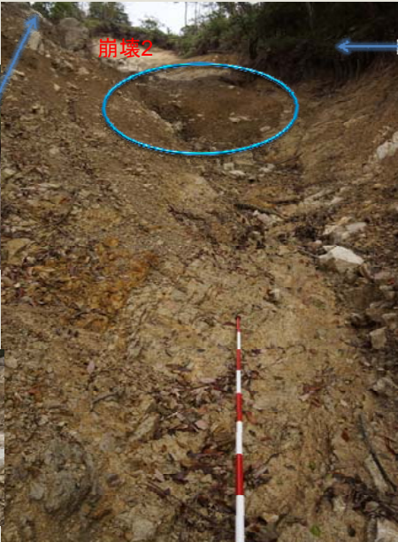
高位における表層崩壊、谷にほぼ平行な節理。崩壊土砂の一部残留。
