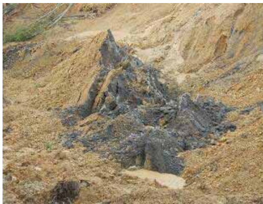
内部の崩落土塊。還元状態で灰色を呈する
