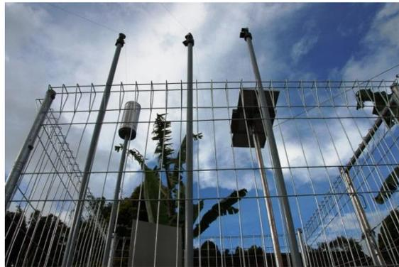
写真18：伸縮計や降雨計による地すべりの観測
